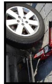
**2** Wagenheber an der dafür vorgesehenen Stelle ansetzen und Rad leicht entlasten. Position the lifting jack off the pressure and take the pressure off the wheel.
